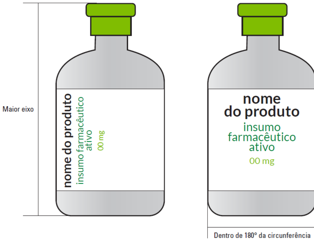
Figura 3 – Impresso paralelo e perpendicular ao maior eixo do recipiente
